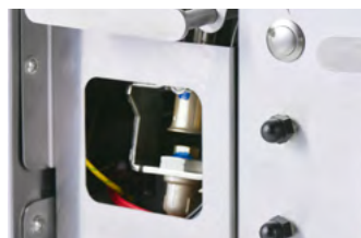
Generador de chispa alimentado a 230 V
